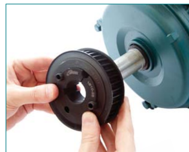
Inserir os parafusos e posicionar no veio
