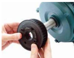
Inserir os parafusos e posicionar no veio
