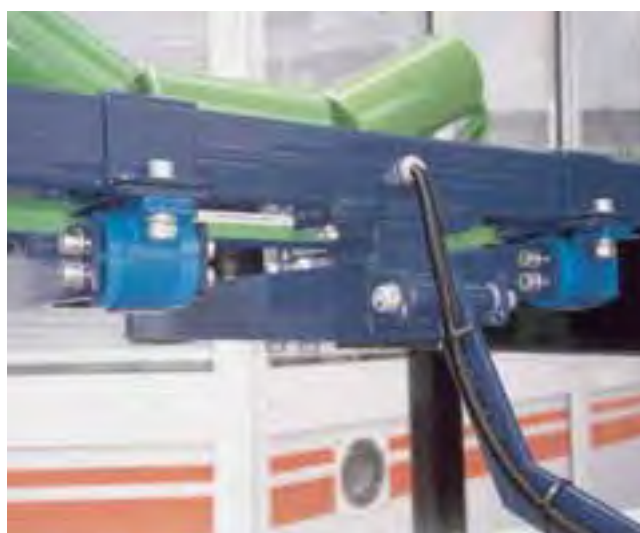
Suporte para dispositivo de pesagem em tela transportadora
