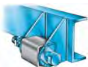
Fig. 19 Fixação ao corpo interno, com furo central, através de um parafuso passante (ver também a página 21)
