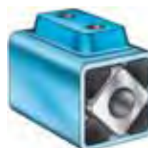
Fig. 6 Através de uma peça roscada soldada ao corpo*
