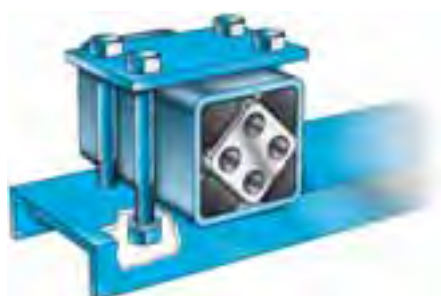
Fig. 8 Através de uma placa e parafusos
