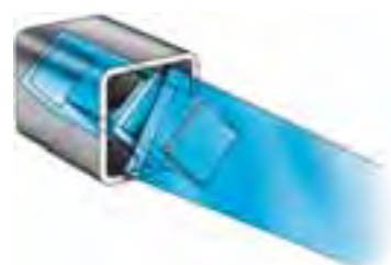
Fig. 13 Acoplamento através de perfil quadrado soldado ao braço (ver também a página 19)
