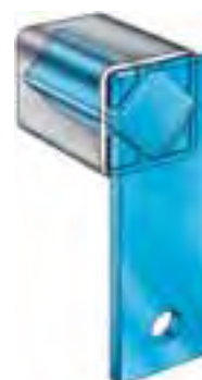
Fig. 18 Perfil quadrado soldado a um braço*
