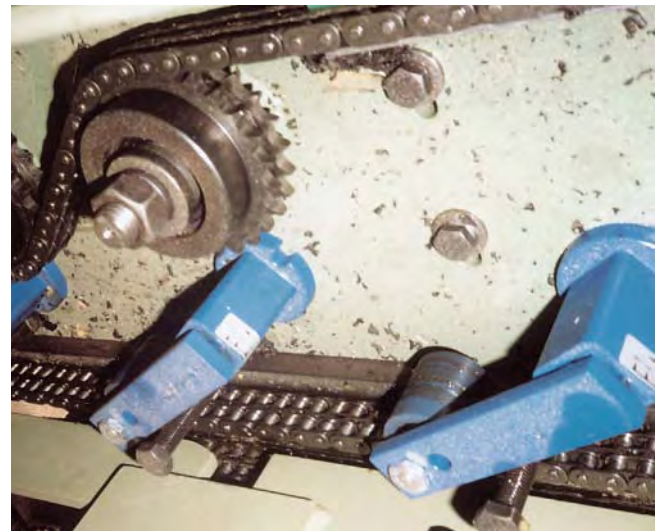
Guiamento elástico da corrente na entrada de madeira
