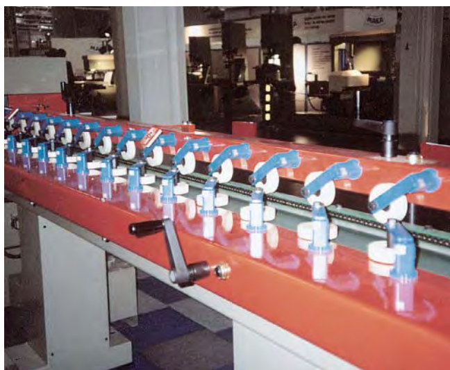
Suspensão de rolos tensores numa fresadora na indústria da madeira
