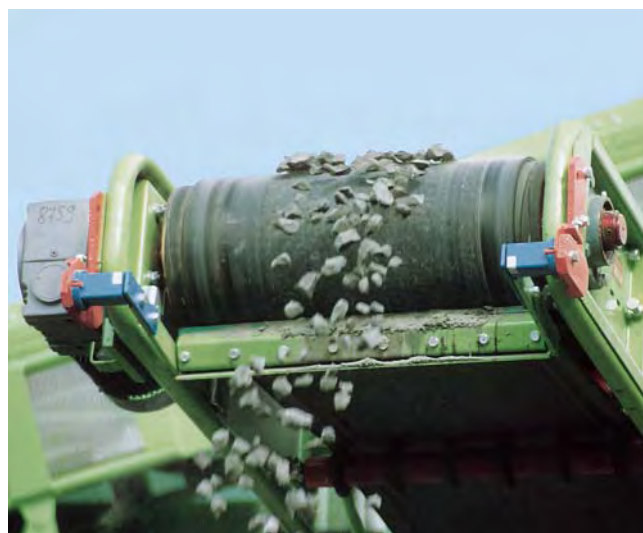
Suspensão elástica num raspador de correia transportadora
