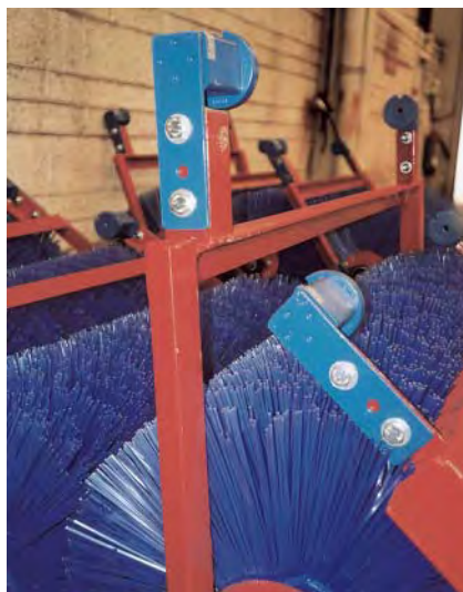
Suspensão de uma escova circular numa máquina de colher batatas
